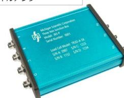
JB3ジャンクションボックスは、複数のTR3Dロードセルの信号を合成し、作用する総力を出力するものです。MSCの3軸ロードセルを最大4台まで接続することができます。JB3は各入力に感度トリミング回路を備えており、各ロードセルの感度を均一化することができます。
